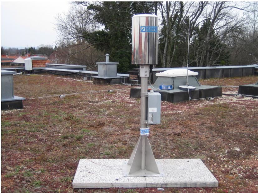
Abbildung 6: Niederschlagsmessstation
