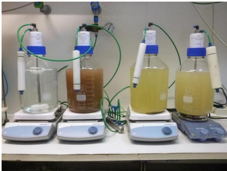
Abbildung 1.11: Abbaueversuch in Bioreaktoren zur Ermittlung des Abbaupotentials am Standort. Versuchsansätze GW/N/B, GW/A/N/B/AK, GW/A/N/B, GW/A (von links nach rechts).
