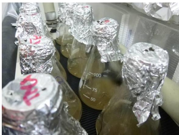
Abbildung 1.5: Abbauversuch Einzelpestizide in 100 mL Schikanenkolben
