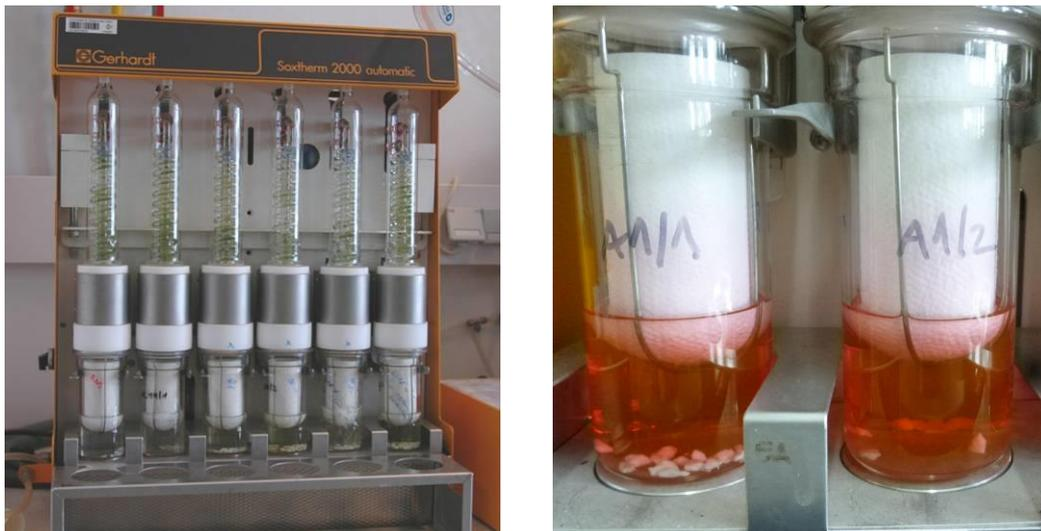
Abbildung 1.4: links Soxtherm-Apparatur und rechts Ethylacetat-Extrakte der Schlammprobe A1
