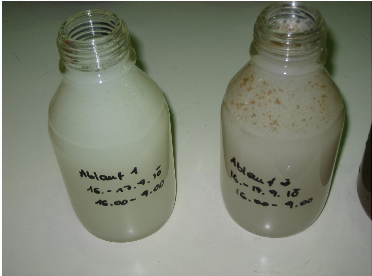
Abbildung 24. Foto der Abläufe der Versuchsanlage (Ablauf 1 [A336][TS] und Ablauf 2 [A336][MTBA]).
