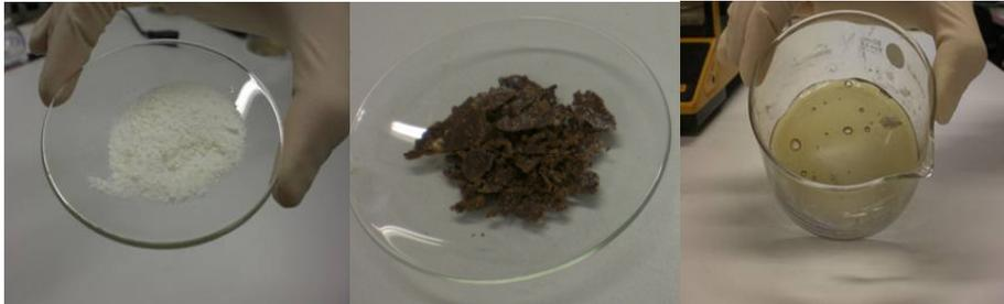
Abbildung 57. Copolymerisierte ionische Flüssigkeiten, die sich durch gewählte Reaktionsbedingungen in Form, Art und Farbe unterscheiden.
