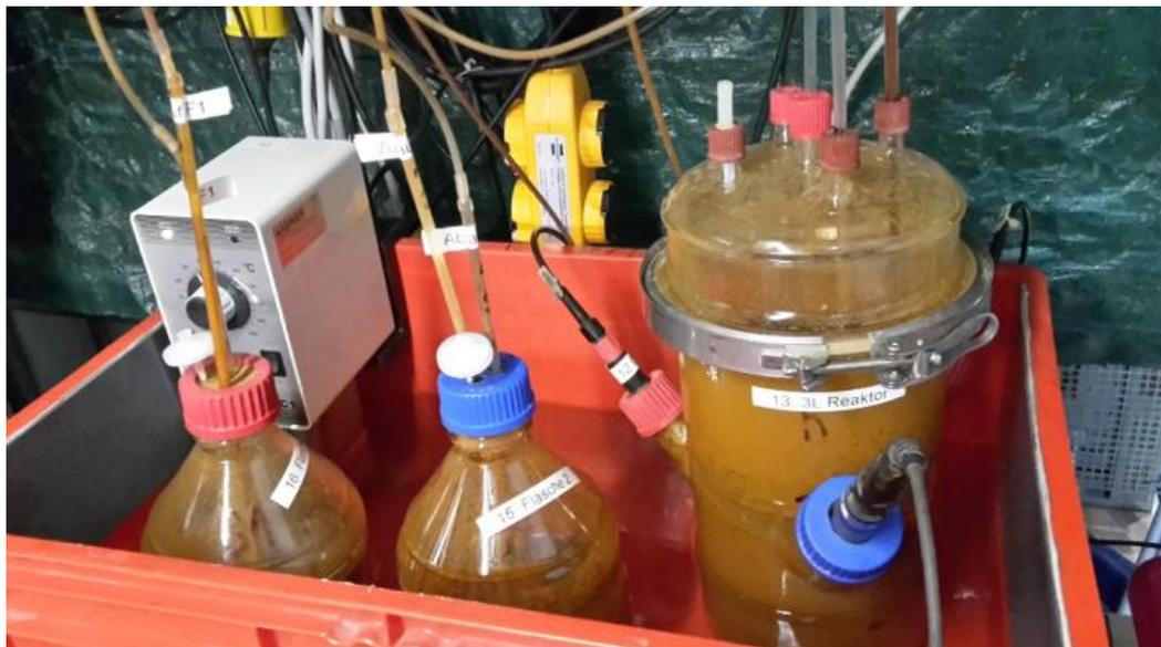
Abbildung 11: 3L – Laborreaktor (SBR) und 1,5L Batchtestreaktoren.
