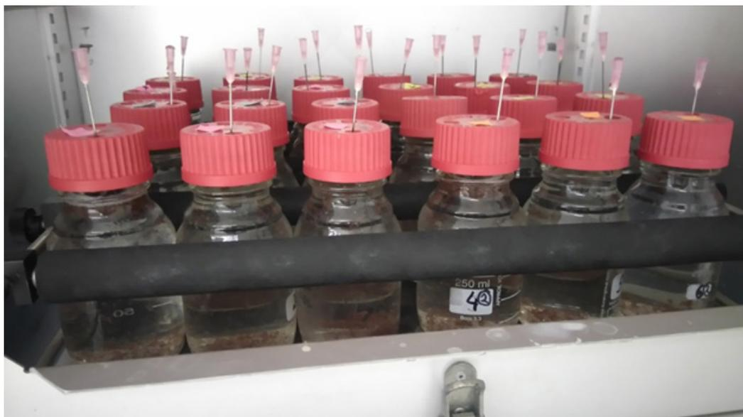
Abbildung 10: Versuchsansatz mit 24 Testflaschen im Inkubator mit Nadeln zur Druckreduktion und Probenahme.
