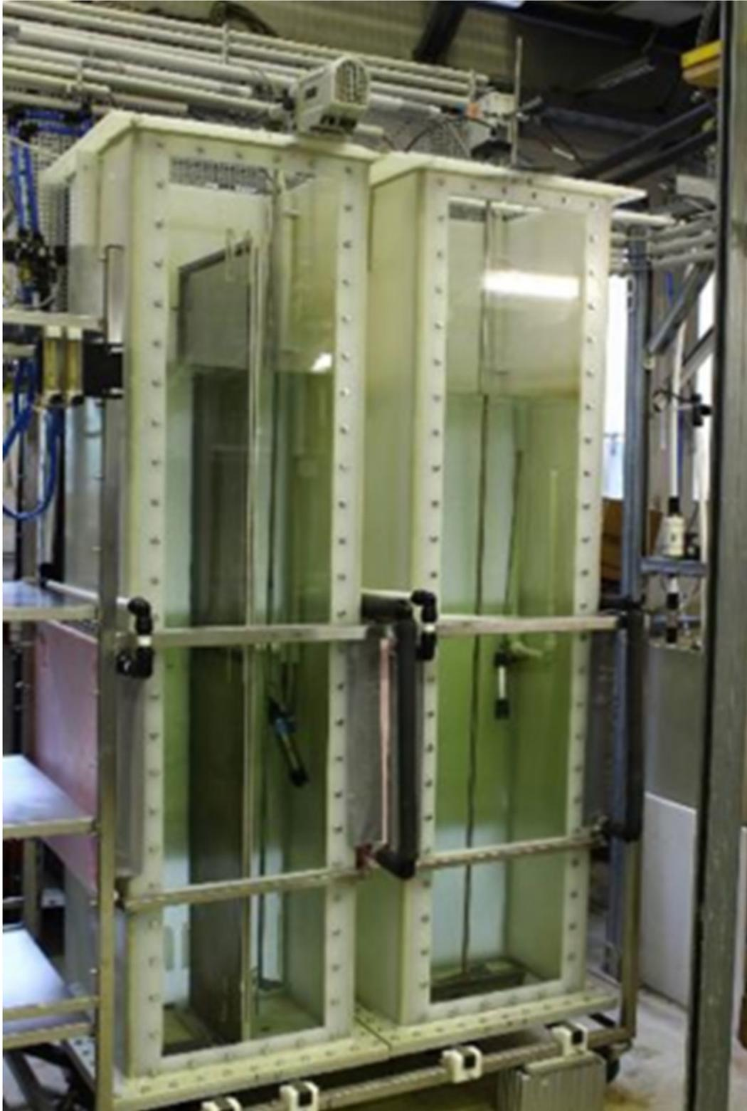
Abbildung 17: Zwei-Kammer-Reaktor (links) und Ein-Kammer-Reaktor (rechts) vor der Inbetriebnahme.
