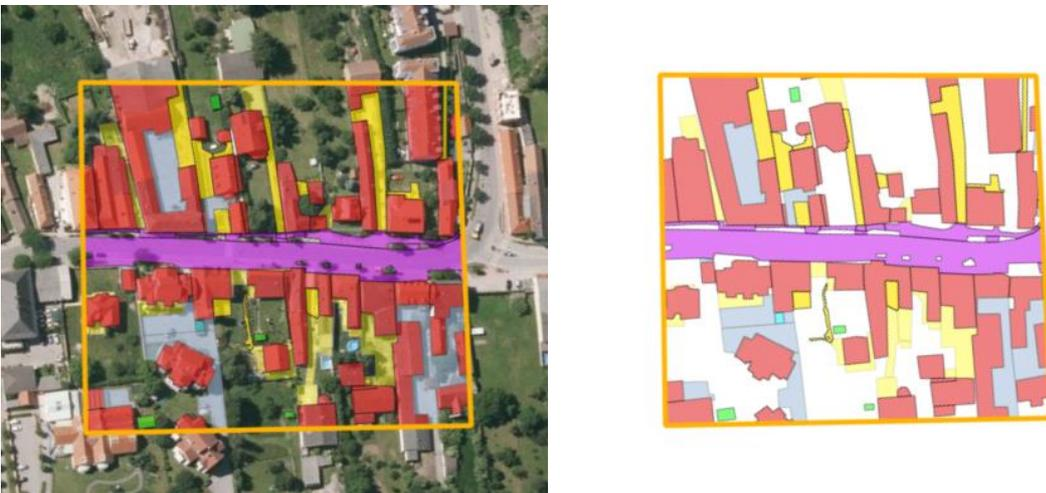
Abbildung 100: Alternative Referenzflächenauswahl: Flächenverschnitt mit rechteckiger (oder zufälliger) Stichprobenfläche zur Detailauswertung (Abbildung mit bzw. ohne Orthofoto im Hintergrund; Datenquelle: GeoDaten Burgenland - geodaten.bgld.gv.at sowie eigene Darstellung aus dem Fallbeispiel)
