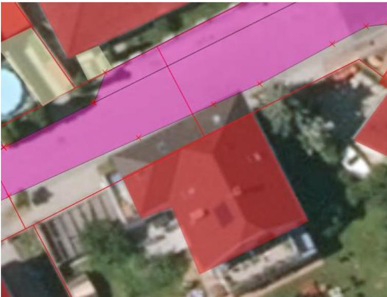
Abbildung 103: Fehlerhafte Teilflächendigitalisierung; Datenquelle: GeoDaten Burgenland - [geodaten.bgld.gv.at](http://geodaten.bgld.gv.at) sowie eigene Darstellung aus dem Fallbeispiel
