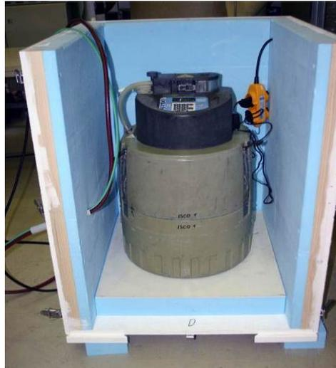
Abbildung 3: Thermobox für die automatischen Probenehmer.
