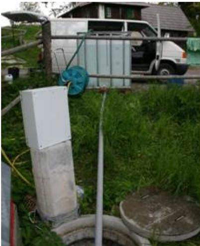
Abbildung 4: Beschickung mit Tracer aus einem 1 m<sup>3</sup> Tank.
