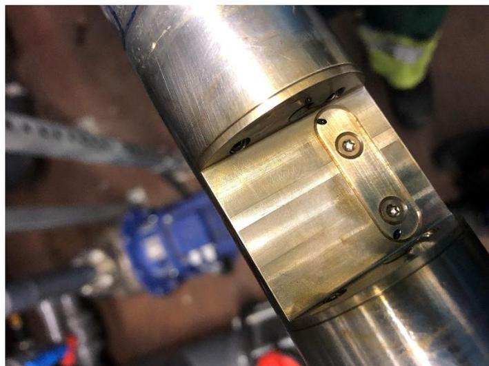
Abbildung 26: Belagsbildung auf den UV-Sonden im Zulauf und Ablauf der KomOzAk-Anlage
