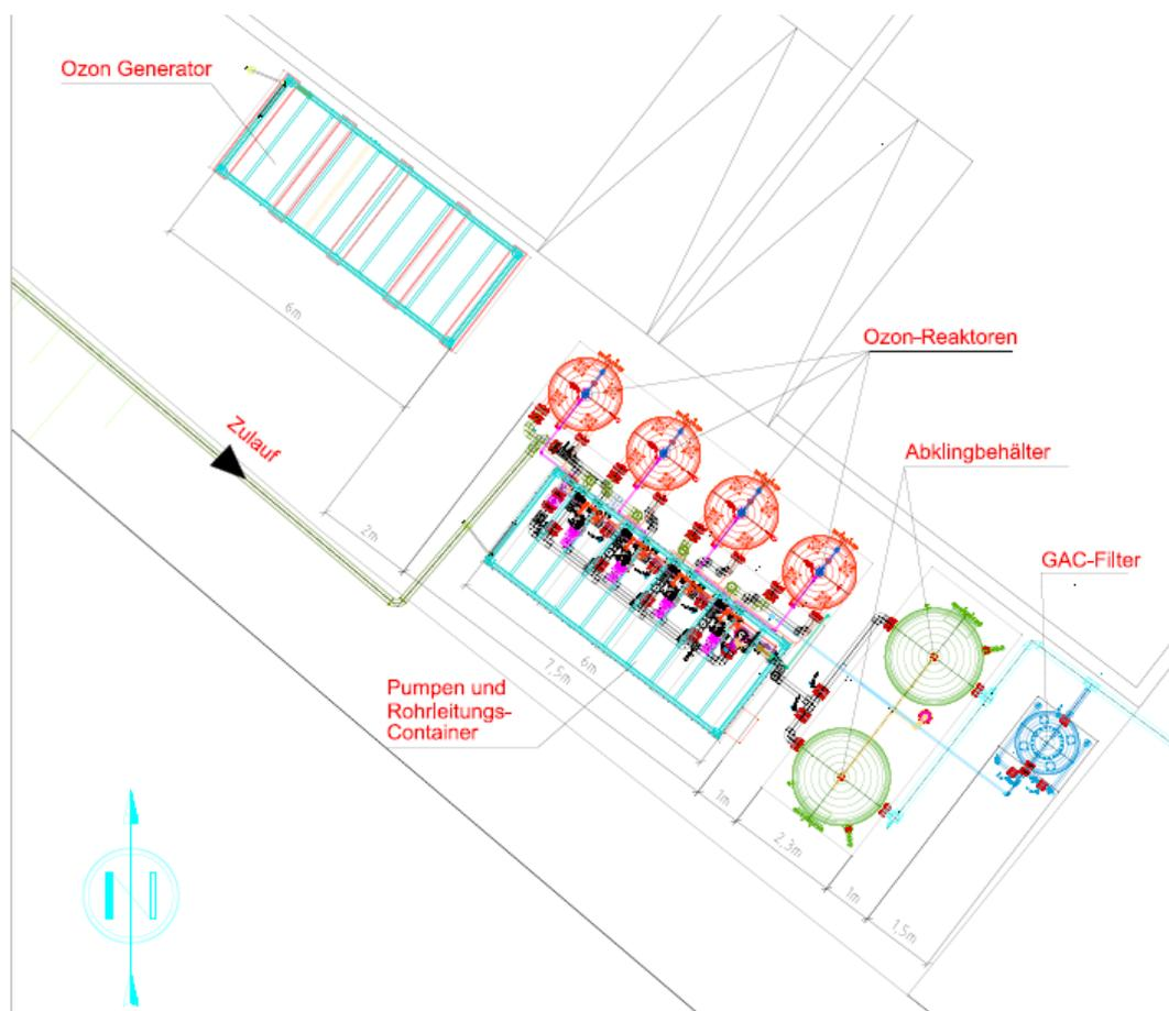
Abbildung 5: Detailplan der Anlagenteile der Versuchsanlage (Ausschnitt aus Aufstellung Detailplan der VA TECH WABAG GmbH)
