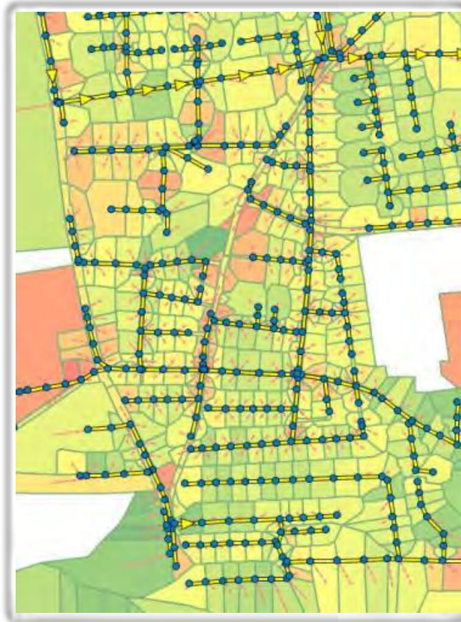
Abbildung 23: *Hydrodynamisches Modell der Holding Graz vom Projektgebiet. Die jeweiligen Einzugsflächen sind entsprechend ihres Befestigungsgrades von gering (grün) bis sehr hohem Befestigungsgrad (rot) gekennzeichnet (HouSui, 2013).*
