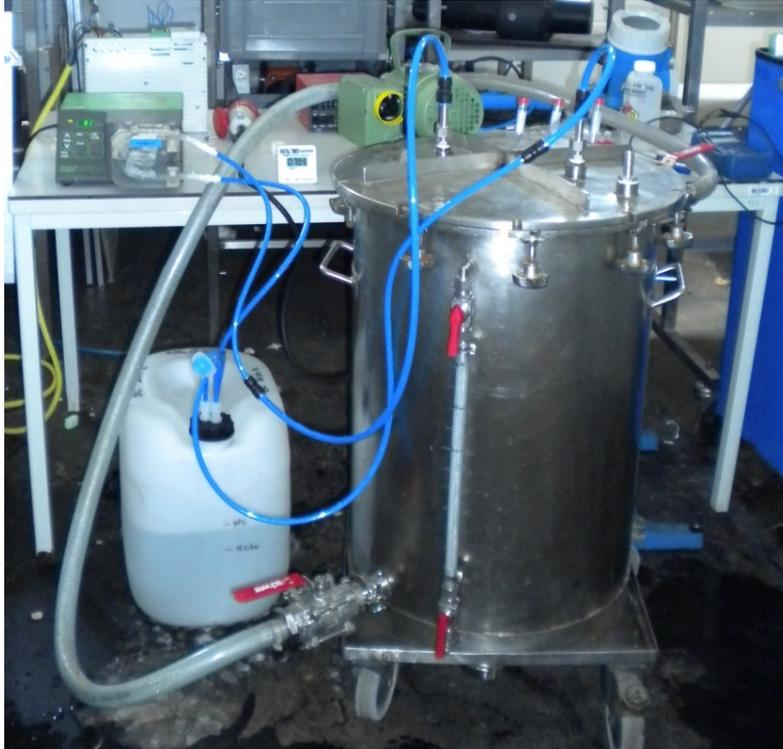
Abbildung 52: Versuchsaufbau für den Transfertest des 3m<sup>3</sup> Moduls
