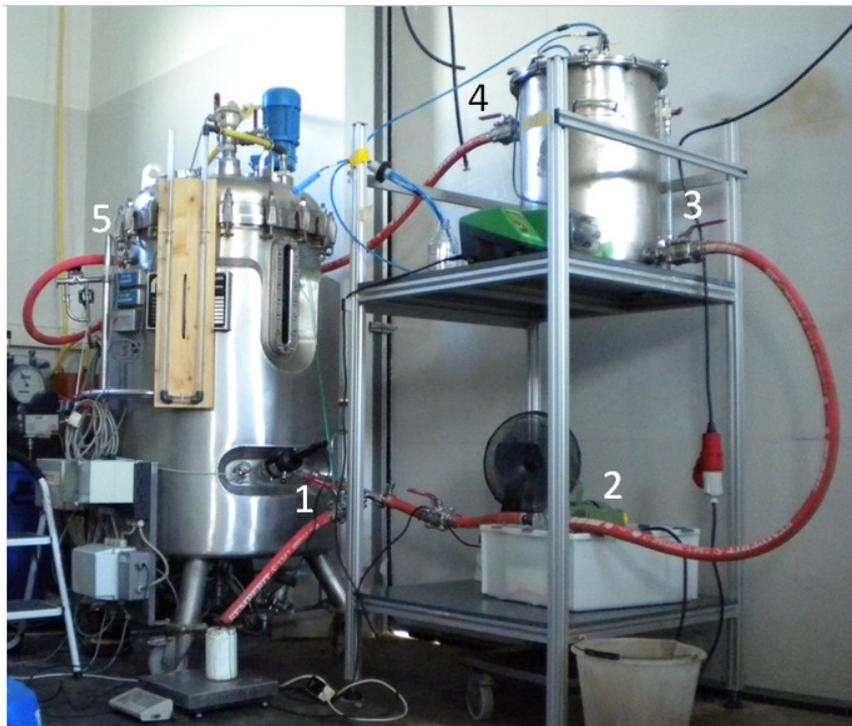
Abbildung 51: Versuchsaufbau nach Anschluss des Modulbehälters (ohne Modul) an den Biogasreaktor: (1) Gärrestauegang mit Probenahmestelle, (2) Gärrest-Pumpe, (3) Gärrest-Eingang des Modulbehälters, (4) Gärrest-Auegang des Modulbehälters, (5) Gärrest-Eingang des Reaktors (ohne Ventil)
