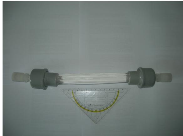
**Abbildung 17:** Vergrößertes Modul mit einer Transferfläche für Versuche bis 10 Liter
