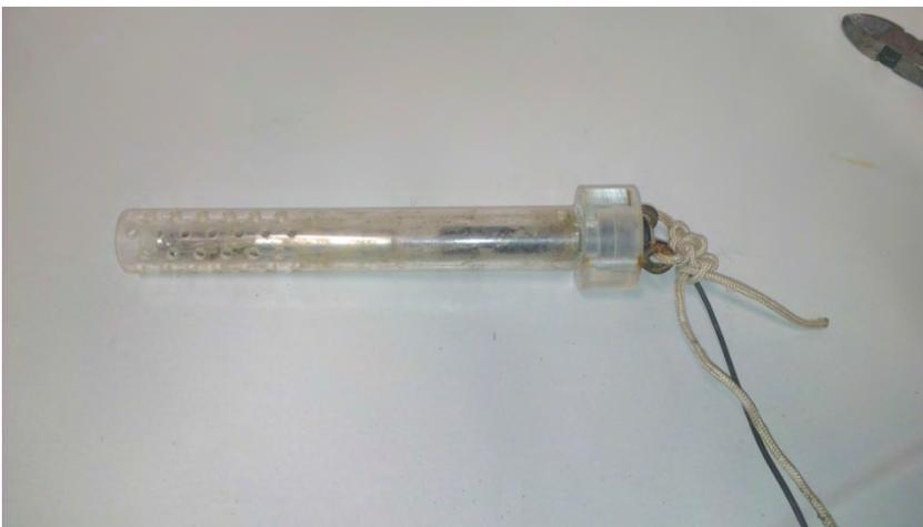
Abbildung 29. Selbstangefertigte Schutzhülle des N<sub>2</sub>O-Mikrosensors.
