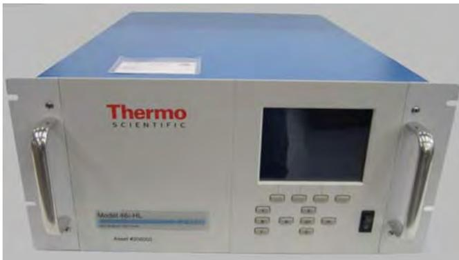
Abbildung 17. IR-N<sub>2</sub>O-Spektrometer Thermo Modell 46i.
