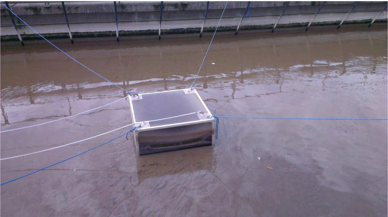
Abbildung 11. Ablufthaube während einer Messung in einem Belebungsbecken.
