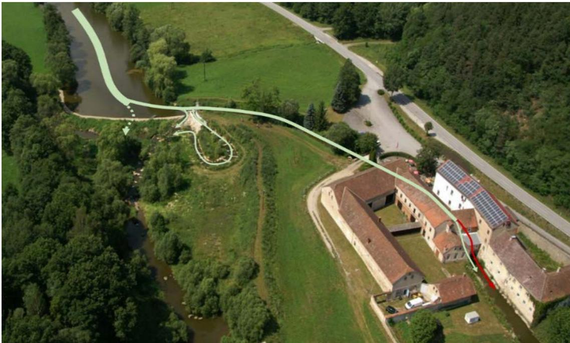
Abbildung 8: Übersicht über die potentiellen Wanderkorridore (grün bzw. Turbinenabstieg rot) für absteigende Fische am Kraftwerk Riedmühle (Thaya). (Fotogrundlage: R. Bentz)
