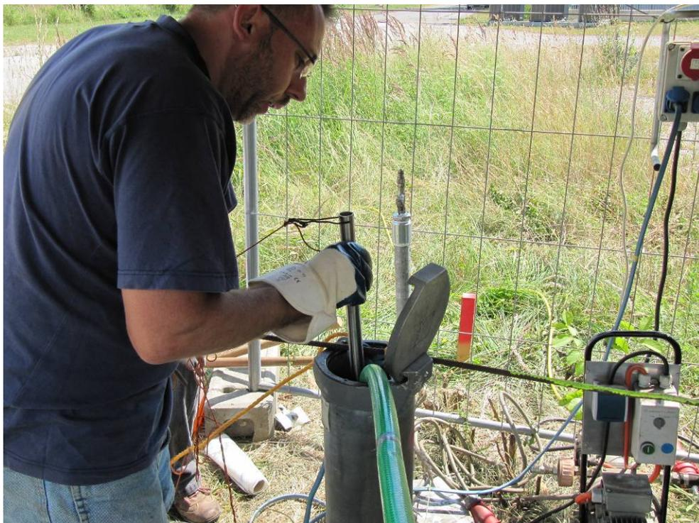
Abbildung 6: Gewinnung einer Schöpfprobe aus dem Pegel BL 5
