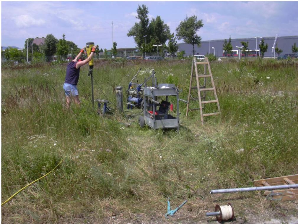
Abbildung 3: Setzen der Infiltrationspegel
