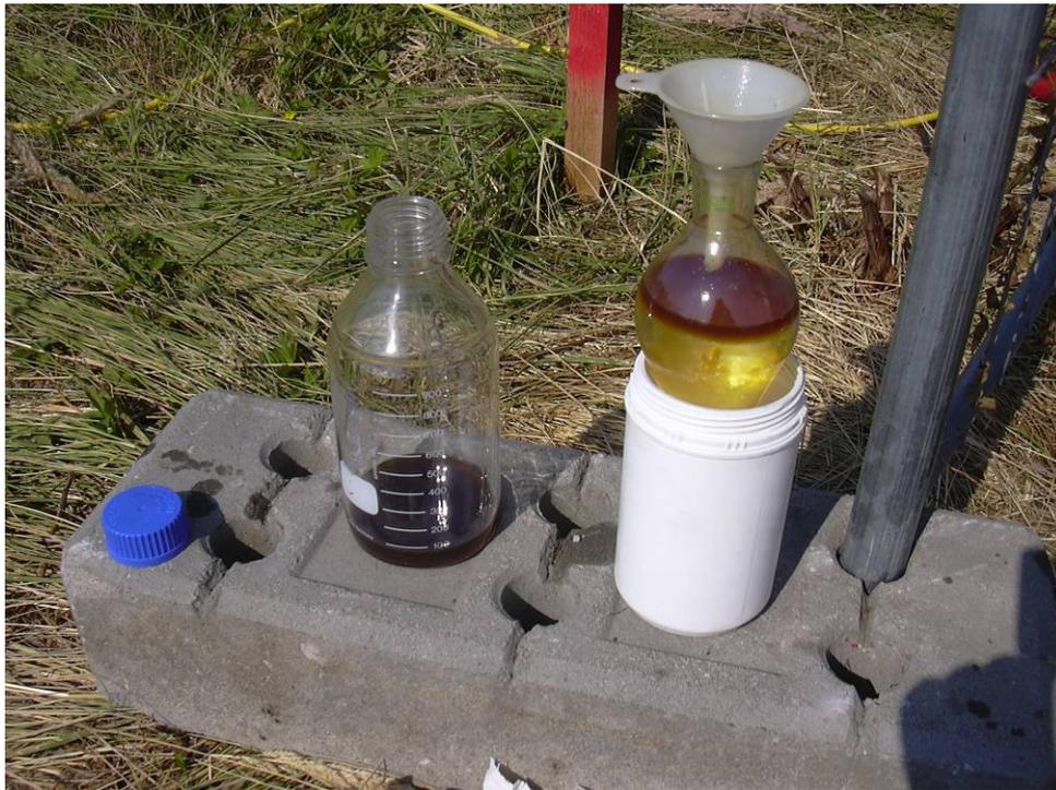
Abbildung 7: Abtrennen des Öles aus der Schöpfprobe mittels Scheidetrichter
