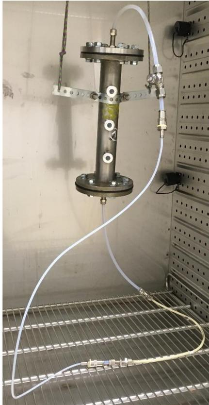
Abbildung 32: Aufbau Säule (ohne Reservoir) für den Säulenversuch PCE
