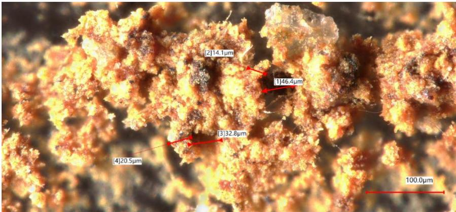
Abbildung 4: Digitalmikroskopische Aufnahme der Aktivkohle des Standortes W18
