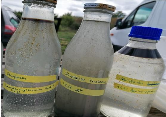
Abbildung 83: Wasserproben aus F-GWB5, Duobrunnen und Sanierungsbrunnen vor Versuchsbeginn (von links nach rechts, aufschwimmende Ölphase deutlich erkennbar).
