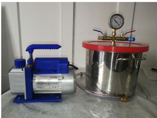
Abbildung 6: Entgasungspumpe und Vakuumkammer zur Entgasung der Emulsion. Dies konnte die Stabilität deutlich steigern.
