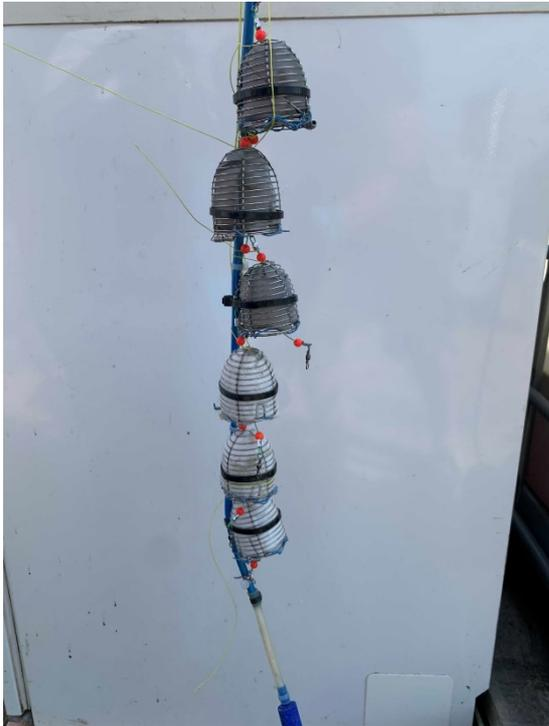
Abbildung 82: Bodenprobe in Metallkörben mit Mesh- bzw. Vlieseinsatz, bereit für die Absenkung in F-DB.
