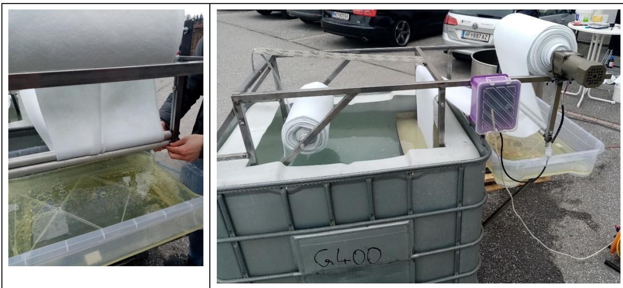
Abbildung 14: Versuche zur Ölabtrennung mit Vliesen. Restölgehalt im Wasser 0,5 bis 1,5mg/l, Wassergehalt im Öl max. 2%.
