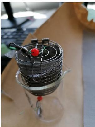
Abbildung 81: Bodenprobe in Metallkorb mit Stahlmesh, bereit für den Feldeinsatz.
