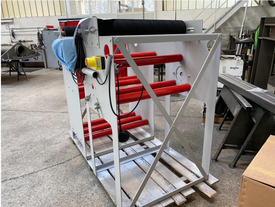
Abbildung 15: Aufbau des Schrägbettfilters (SBF) auf Ergebnissen des Scale-up. BCA, FH Technikum Wien und Spintec haben hier eng zusammengearbeitet.
