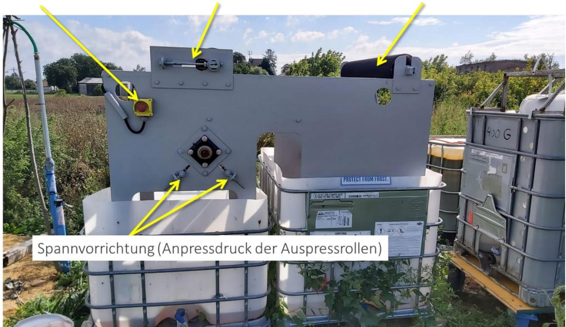
Abbildung 97: Details Schrägbettfilter
