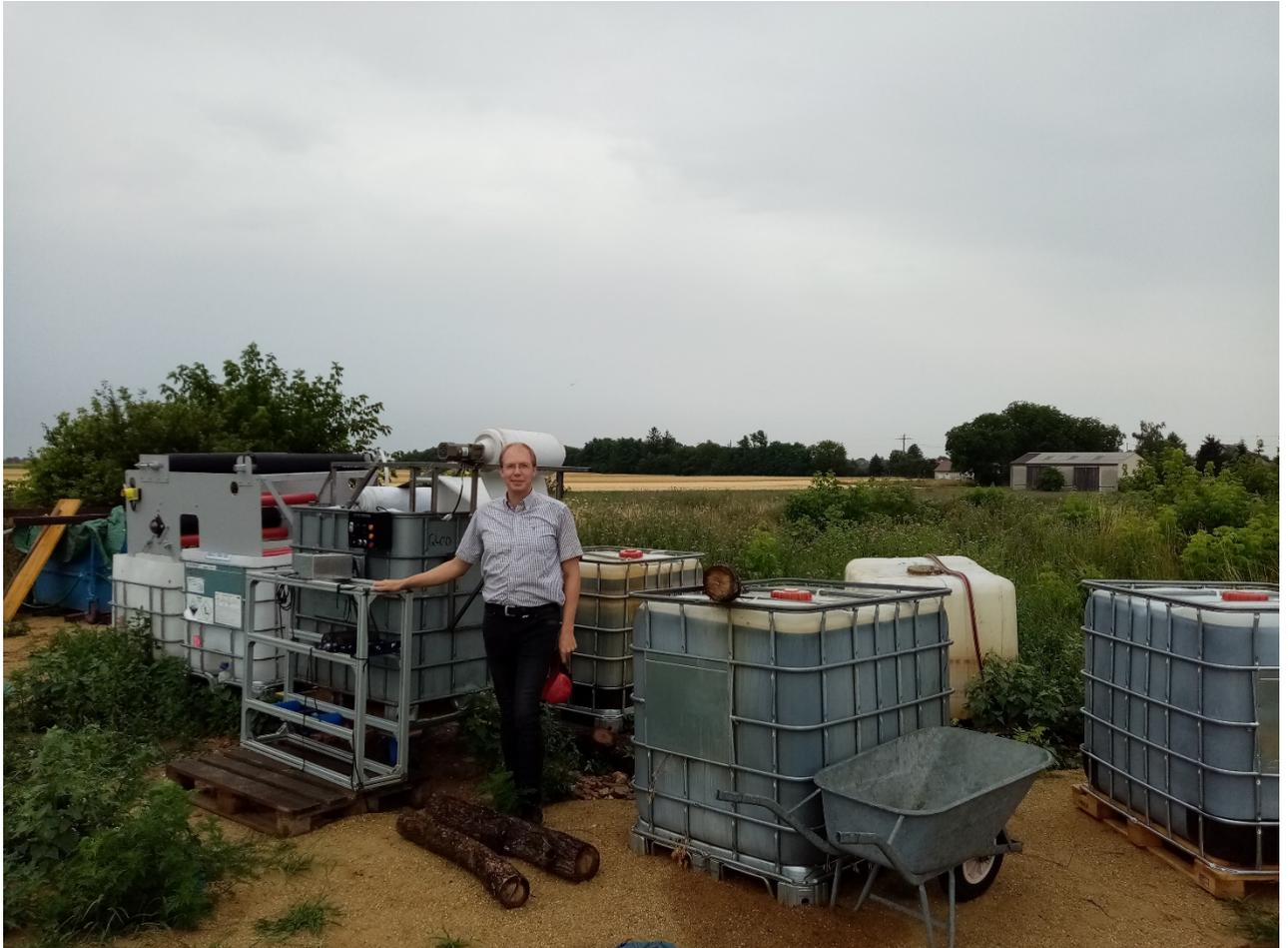
Abbildung 16: Bei den Feldversuchen. Zu erkennen sind 2 IBC mit Pflanzenöl/Mineralöl, die mittels Schrägbettfilter abgetrennt werden konnten aus den geförderten 500m<sup>3</sup> Grundwasser.
