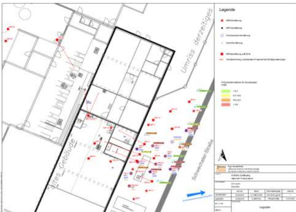
Abbildung 32 Ergänzende MIP-Kampagne. Lageplan der Vertikal- und Schrägsondierungen
