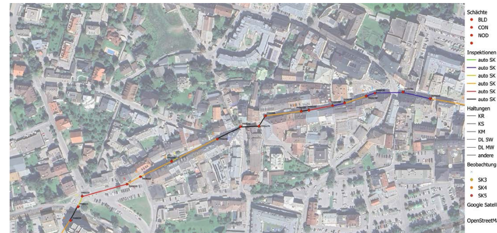
Lageplan eines Kanals mit Kennzeichnung der Schadensklassen
