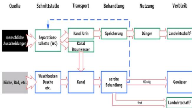
Abbildung 3: Variante B für Beispiel kreislauforientierten Abwassersystemen für Einzelanlagen
