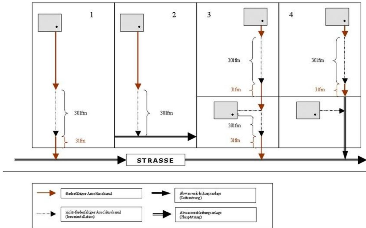
Abbildung 1:(Haus)Anschlusskanäle - Fallbeispiele
