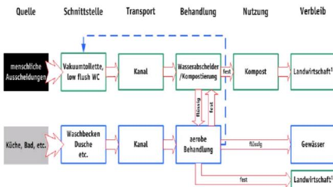
Abbildung 4: Variante C für Beispiel kreislauforientierten Abwassersystemen für Einzelanlagen
